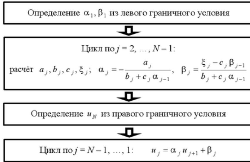
Рис. 10.1. Блок-схема решения разностной схемы (10.2) для случая k > 0
